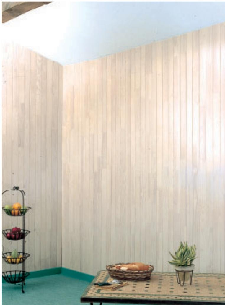
**L**e lambris en bois, qui se présente sous la forme de lames de bois qu'on appelle aussi de la frissette, est un revêtement très esthétique, en particulier lorsque l'on choisit un modèle verni ou en couleur. On utilise aussi des lames en plastique (PVC) particulièrement adaptées aux pièces humides.
